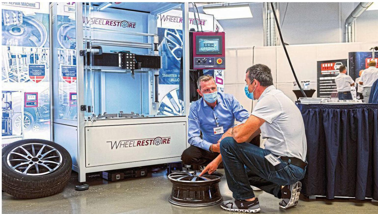
Mit dem „Wheelstore“ können glanzgedrehte Felgen mit Größen von bis zu 30 Zoll optisch aufbereitet werden. Dabei ist die Bearbeitung mit oder ohne Reifen möglich.
