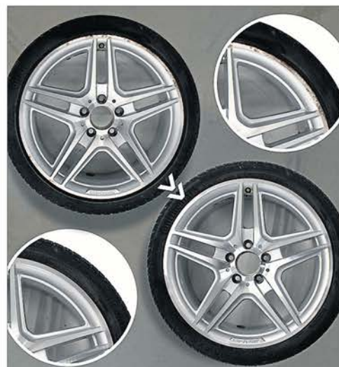
Mange danske biler har én eller flere alufælge med ridser og skræmmen, der sagtens kan repareres, påpeger firmaet. Her er det før og efter reparation. (Foto: Wheel Restore)
