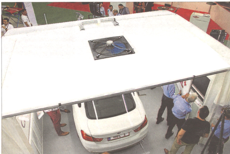
Her ses sprøjtekabinen i en indendørs-version. Foruden den centrale del af konstruktionen lukker et par elektriske markiser ned i hver ende, så bilens lukkes til. (Foto: Henrik Nordstrøm Mortensen)
