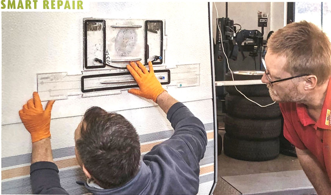
1 Bei Rissen in der Außenhaut werden die Kanten der Schadstelle nach innen geschlagen.
