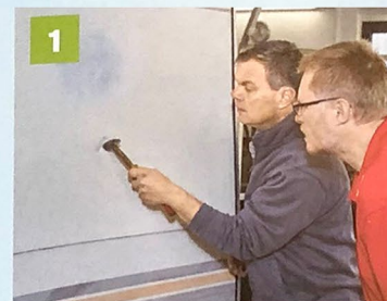
1 Bei Rissen in der Außenhaut werden die Kanten der Schadstelle nach innen geschlagen.
