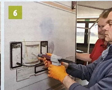
6 Hinter die zweite Platte wird 2K-Negativmasse gespritzt, die dann den Hammerschlag überträgt.
