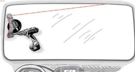
Den Akkuschrauber langsam rechts laufen lassen, dabei je nach Belastung die Drehzahl anpassen. Bei diesem Vorgang den Austrennschutz innen zwischen Scheibenaustrennschnur und Armaturenbrett- bzw. Holmen- und Dachhimmel so halten, dass keine Schäden am Innenraum entstehen können. Den Trennvorgang nun so lange fortführen bis die Scheibenaustrennschnur die untere rechte Ecke erreicht hat.
