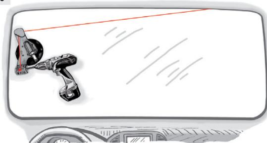
Faites tourner la visseuse sans fil lentement en mode vissage en modifiant la vitesse de rotation selon le besoin. Lors de cette opération, maintenir la protection de découpe intérieure entre la corde de découpe et le tableau de bord ou les barres et le ciel de toit afin que l'intérieur du véhicule ne puisse pas être endommagé. Poursuivre la découpe jusqu'à ce que la corde de découpe ait atteint le coin inférieur droit.
